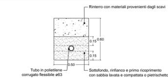
Particolare sezione di scavo cavodotto elettrico
