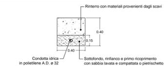
Particolare sezione di scavo condotta idrica
