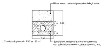
Particolare sezione di scavo condotta fognaria
