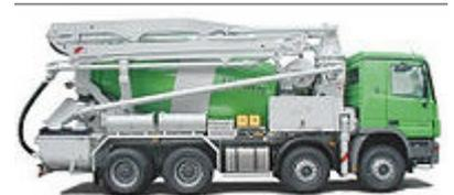
Qualora per lo scarico si debba operare in posti poco accessibili si utilizzano dei camion betoniera dotati di un braccio estensibile con annesso un tubo: una pompa consente al cemento di scorrervi all'interno per effettuare la gettata nel luogo voluto.
